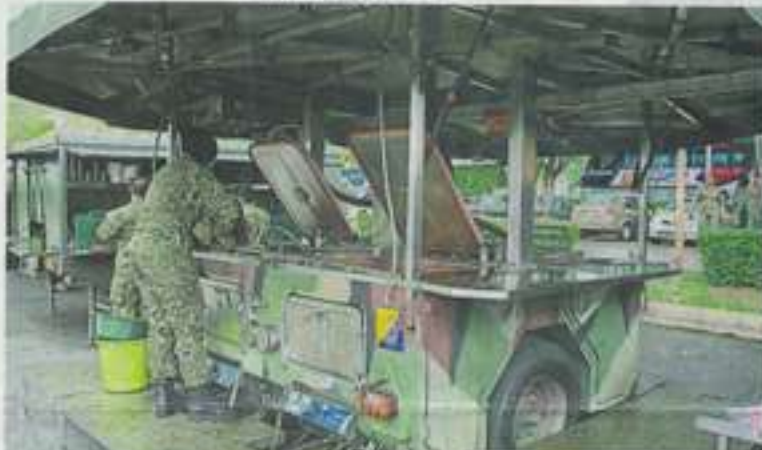
■型号为OZTI-850的战时流动厨房，重2420公斤，上端是4个炉，下端则是烧烤炉，可同时烤肉、炒菜及蒸饭。
