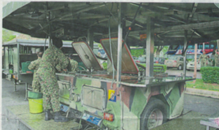
■型號為OZTI 850的戰時流動廚房，重2420公斤，上端是4個爐，下端則是燒烤爐，可同時烤肉、炒菜及蒸飯。
